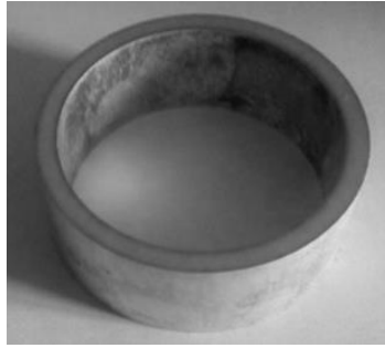
Рисунок. Кольцевой пьезоэлемент, изготовленный из керамики ЦТС-19 с внутренним радиусом 60 мм и внешним радиусом 70 мм. Элемент поляризован по радиусу
