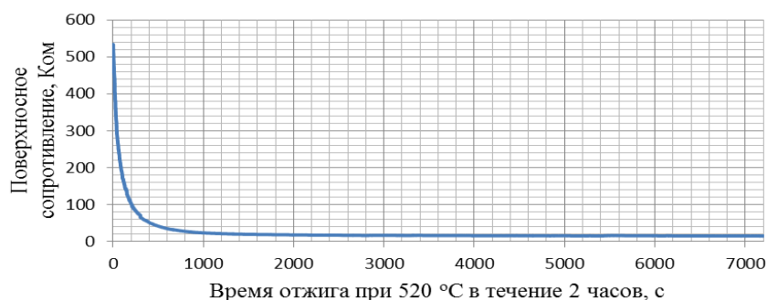
Рис.3 Снижения поверхностного сопротивления от времени отжига
